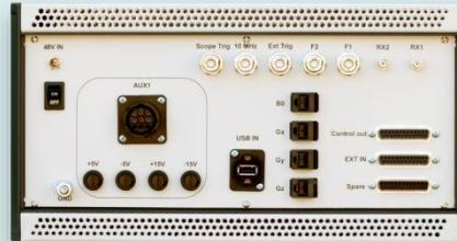
SCOUTは、コンパクトで拡張可能なクラスタベースのコンソールです。マスター-クラスタは広帯域送信機とデジタル受信機を備えており、Windows10/11 Pro 64ビットPCでUSB2.0により制御します。オプションのセカンドクラスタは、2つ目となる送信機か受信機、またはシングルスライスイメージングか拡散実験用のグラジェント制御への拡張が出来ます。
