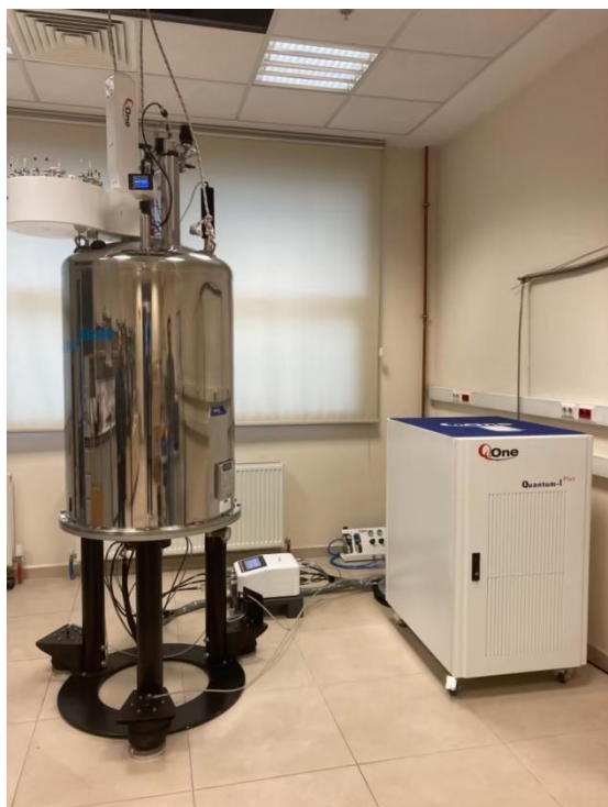
既存のVarian製マグネット および Q.One NMR システム(コンソール、サンプルチェンジャー等)
